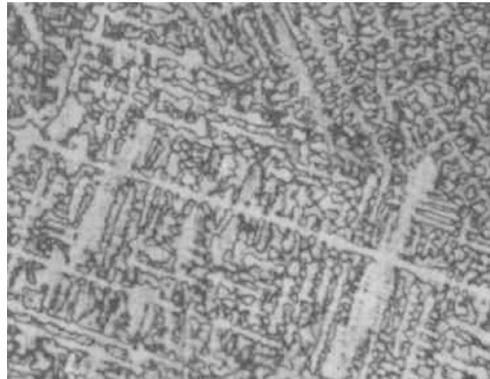
图1 C90500铸态组织  $\alpha + (\alpha + \delta)$  100 ×
