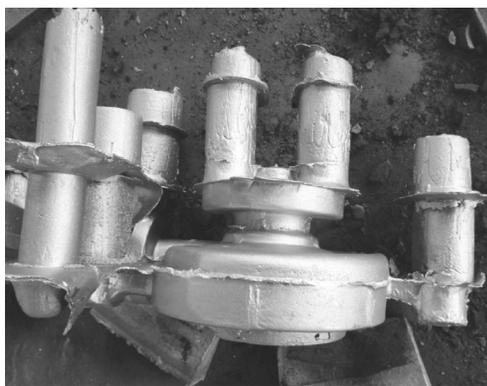
图5 浇注后的铸件状态
