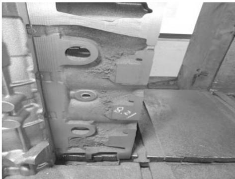
图7 油道粘砂铸件
