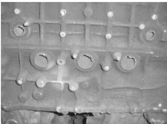
图3 缸体左侧面气孔
