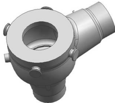
图2 阀壳三维模型
