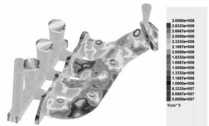
图13 排气歧管本体 $X$ 方向珠光体的含量
