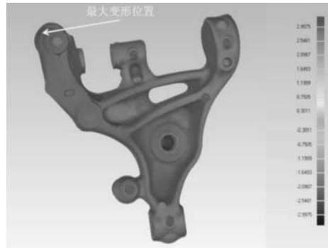
图10 汽车转向节变形分布云图（实测）
