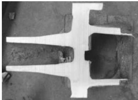
图8 改进后铸件解剖结果
