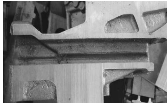
图13 增加芯骨后铸件油道部位解剖图
