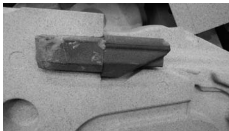
图6 热熔胶提前固化
