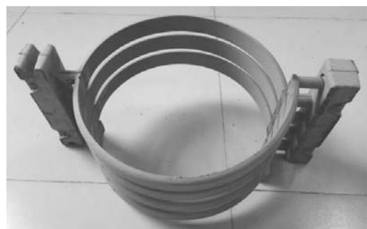
图10 螺旋砂芯成品
