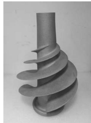
图7 诱导轮铸件
