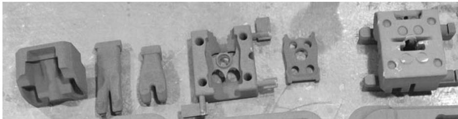
图8 打印完成的砂芯
