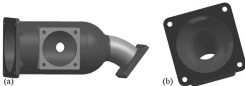
图1 复杂混流泵外壳的三维结构
