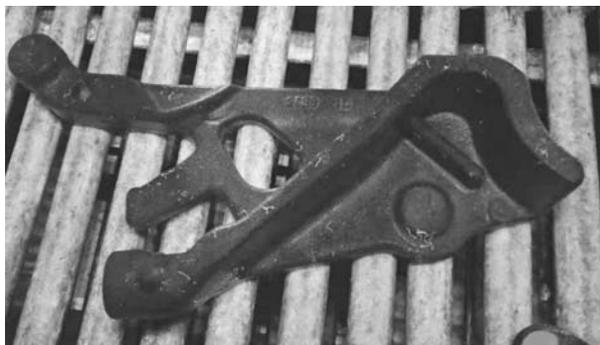
图14 防护杆磁粉检测结果
