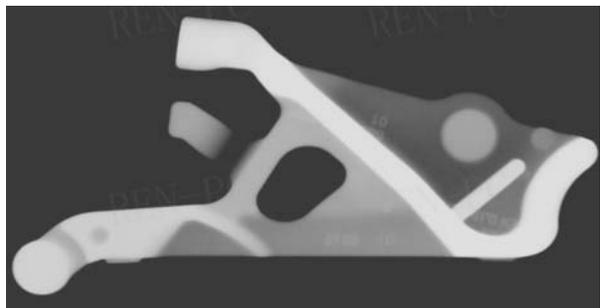
图12 防护杆X射线检测结果
