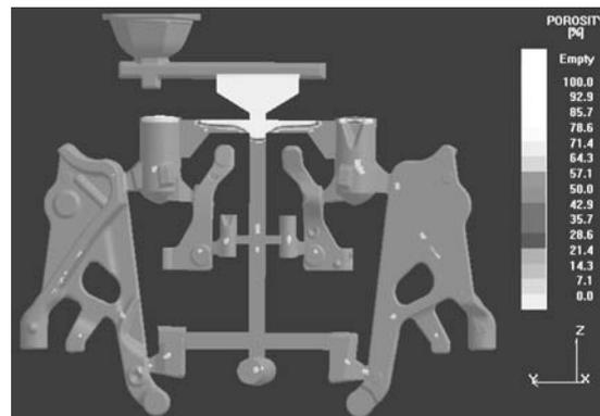
图6 缩孔缩松分布模拟结果
