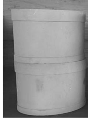
图9 无缺陷舱体铸件
